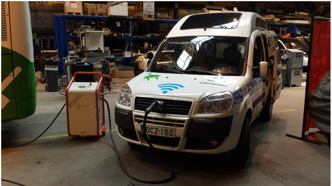
Kuva 1. Fiat Doblo pikalatauksessa CHAdeMO-standardin mukaisella pikalatauslaitteella
