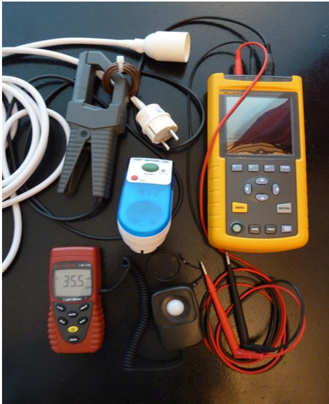
Kuvio 4. Valaistusvoimakkuusmittari, vikavirtasuojakytkin, energia-analysaattori ja virranmittauspihti.
