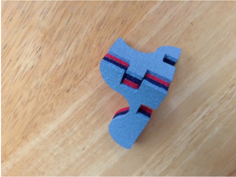
Kuva 24. Liitos ei istu toivotulla tavalla. (Vähämaa, 2014.)
