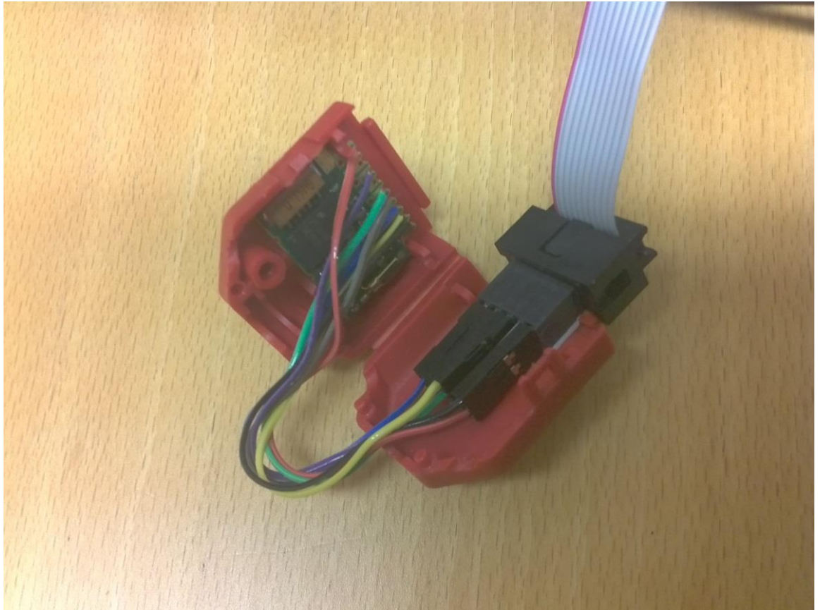
Kuva 26. ARF32-moduuli on juotettu kiinni liittimeen ja asennettu suojakoteloon.
