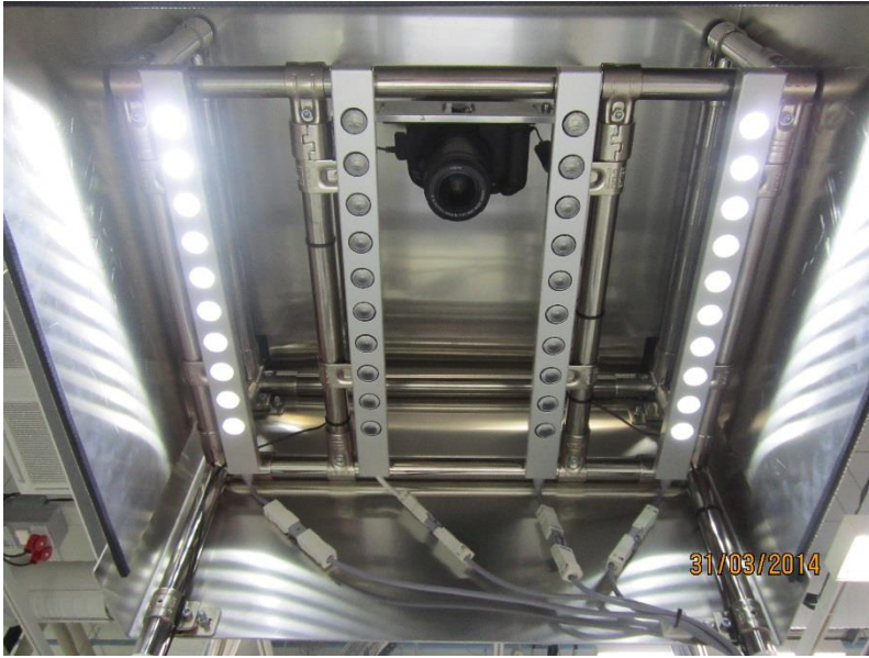
KUVA 20. Kameran ja valojen asettelu suojakotelon sisällä
