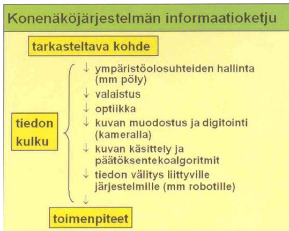
KUVA 1. Konenäköjärjestelmän informaatioketju (1, s. 8)
