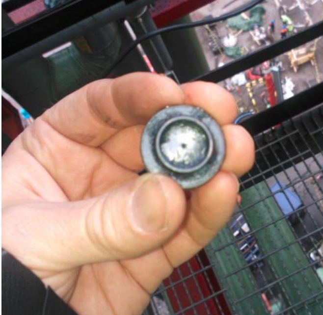
Kuva 28. 2. reaktorin kaasupursutuslinjan RO-levy.
