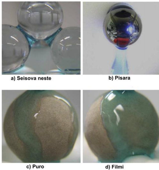
Kuva 19. Erilaisia nestevirtauksen olomuotoja [24, s. 760, muokattu].
