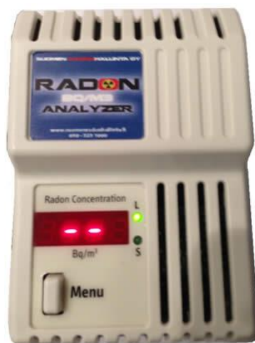
Kuva 19. Radon pika-analysointilaitteet (48 h) (Suomen radonhallinta Oy)
