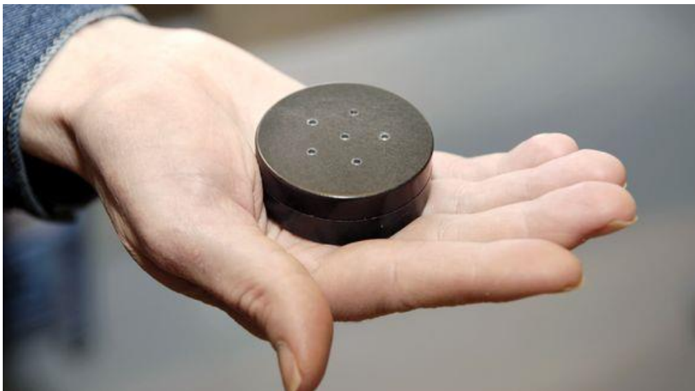
Kuva 10. Säteilyturvakeskuksen radonmittalaite pinnalta. Kuva osoittaa mittapurkin pienen koon (Yle Uutiset www-sivusto 2013)
