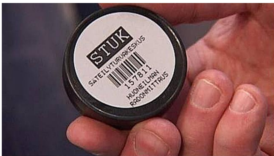
Kuva 8. Säteilyturvakeskuksen radonmittalaite pohjasta (Yle Uutiset www-sivusto 2013)
