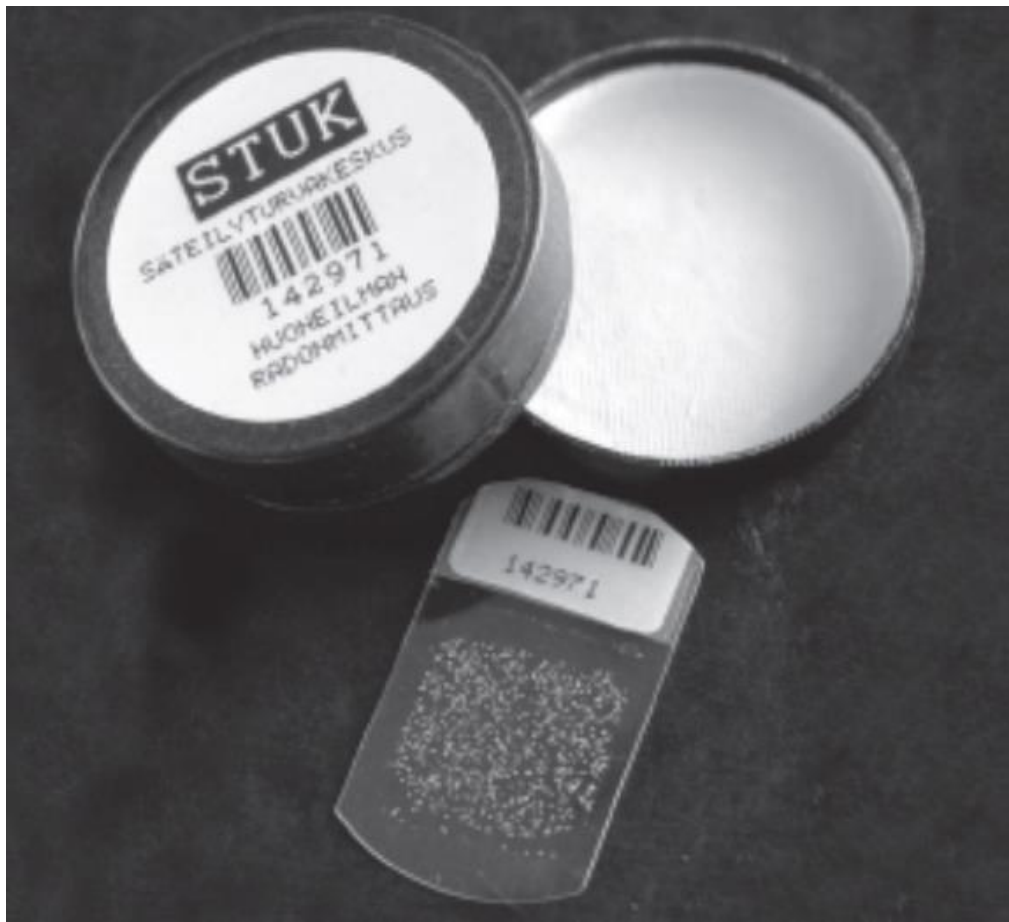
Kuva 9. Säteilyturvakeskuksen radonmittalaite avattuna. Näkyvissä etsattu alfajälki-ilmaisain (STUK www-sivusto 2012)
