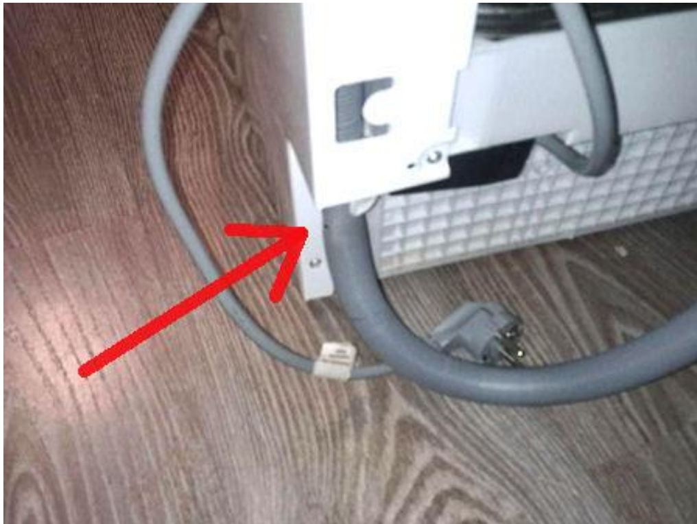
Kuva 9. Vuotokohta poistoletkussa (If Vahinkovakuutusyhtiö Oy, henkilökohtainen tiedonanto 12/2013).
