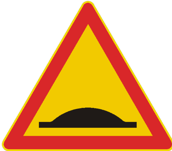
Kuva 17. Varoitusmerkki 141a. Töyssyjä (Tiehallinto 2014)
