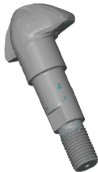
Kuva 22. Lukkotapin skannattu pintamalli (Ylitolva 2013, 8).
