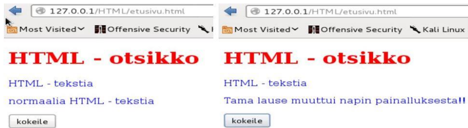
Kuva 10. JavaScript-esimerkki ennen ja jälkeen napin painallusta. Uutta HTTP-kyselyä ei suoritettu, vaan toiminto suoritettiin selaimessa.
