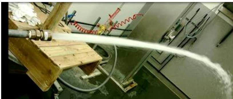
Kuva 31. Vesisuihku NEMA4X vesisuihku testissä.
