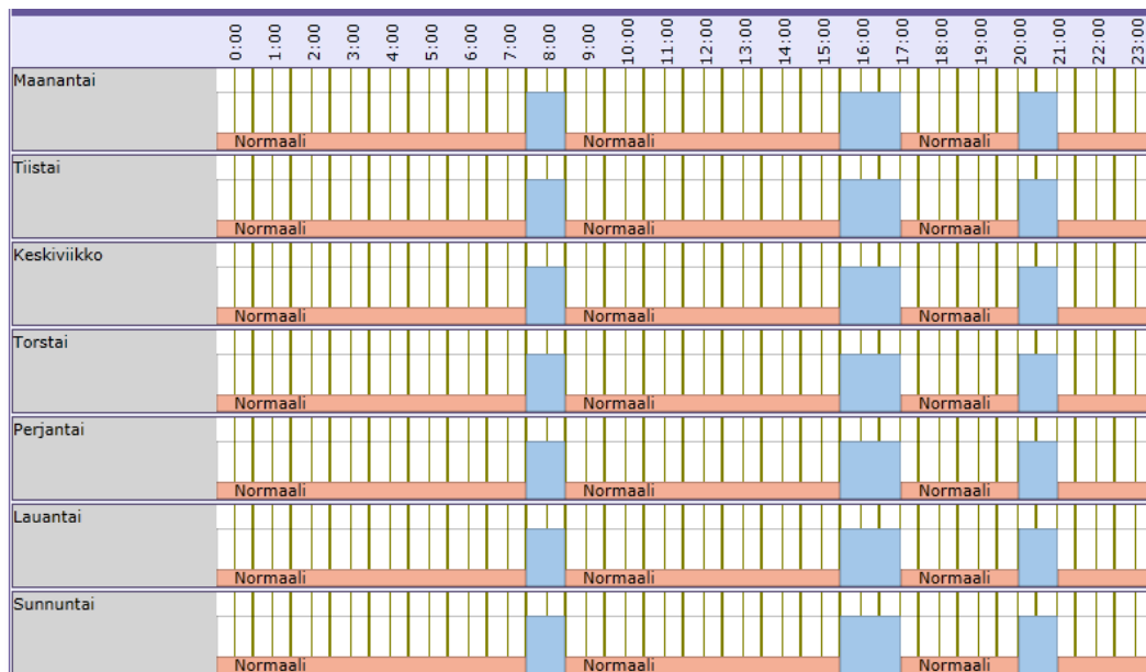
KUVA 5. Ilmanvaihdon ilmavirtojen tehostus kellonajan mukaan /16/
