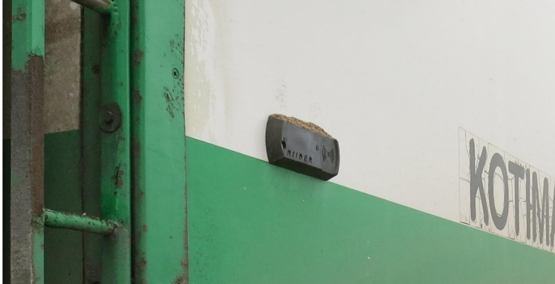
KUVA 24. Kotelon päälle lastausvaiheessa kertyvä lika (Jarno Föhr 2014)
