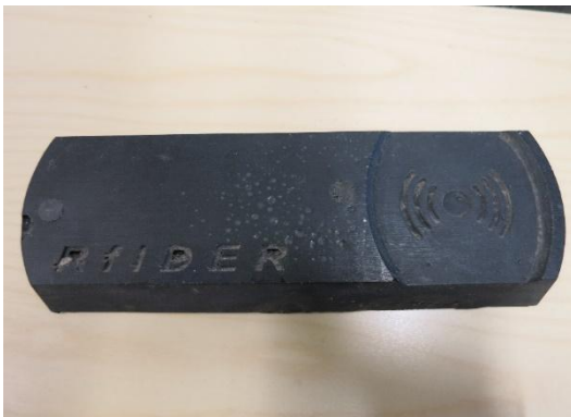
KUVA 18. Valmiiseen koteloon jääneet valuvirheet (Jarno Föhr 2014)
