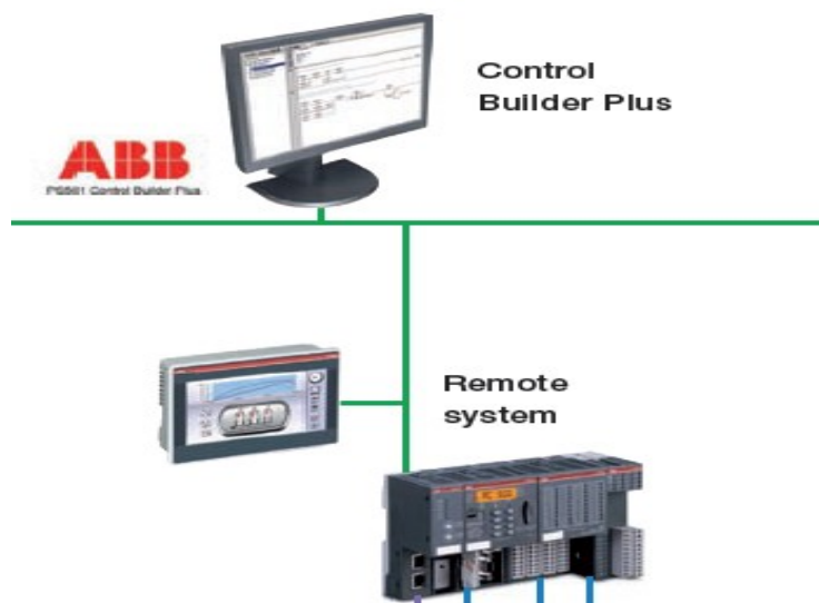
Kuvio 25. Esimerkki, AC500 liitettynä ohjauspaneeliin ethernet yhteydellä (ABB Oy 2012. Industrial automation).
