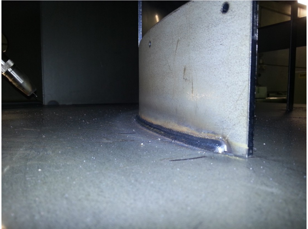
Kuva 21. RTPM-prosessilla hitsattu kaaripelti.
