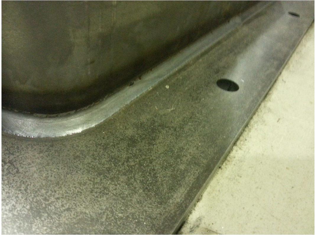
Kuva 19. Tuotantohitsauksen hyvä laatu.
