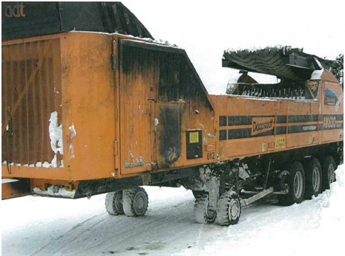
Kuva 2. Dobbstadt ak 630 murskain tulipalon jälkeen. (Pohjaset Oy, palovahinkoraportti pdf, 20.5.2012)
