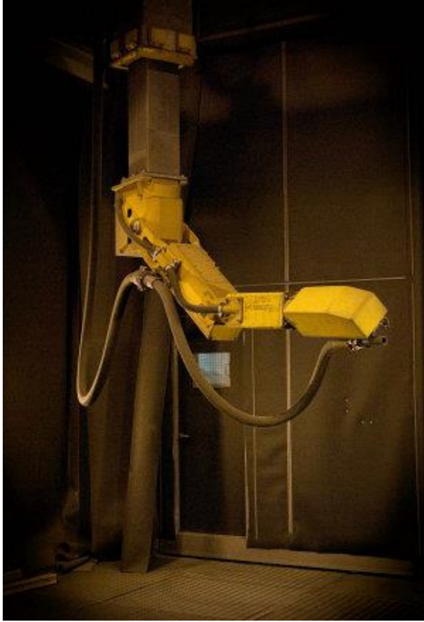
Kuva 3. Blastman B20-S -raepuhallusrobotin käsivarsi [9.]
