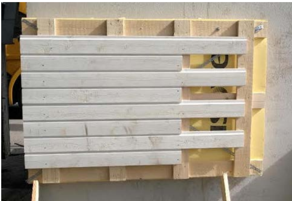
KUVA 2. Kevyt puuvuori -elementti. Kiinnikkeiden koekuormitus.(Kataja 2014)
