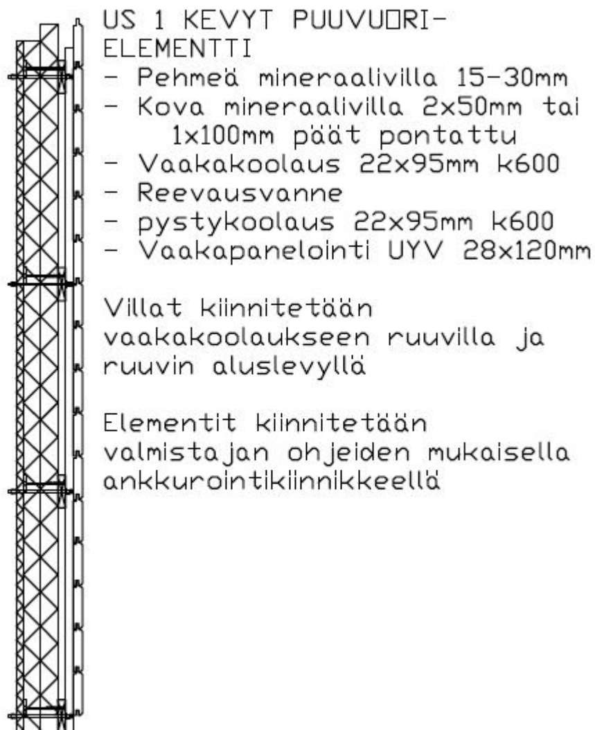
KUVA 3. Kevyt puuvuori -elementti. Rakennekuva, pystyleikkaus vaakapaneloinnilla.
