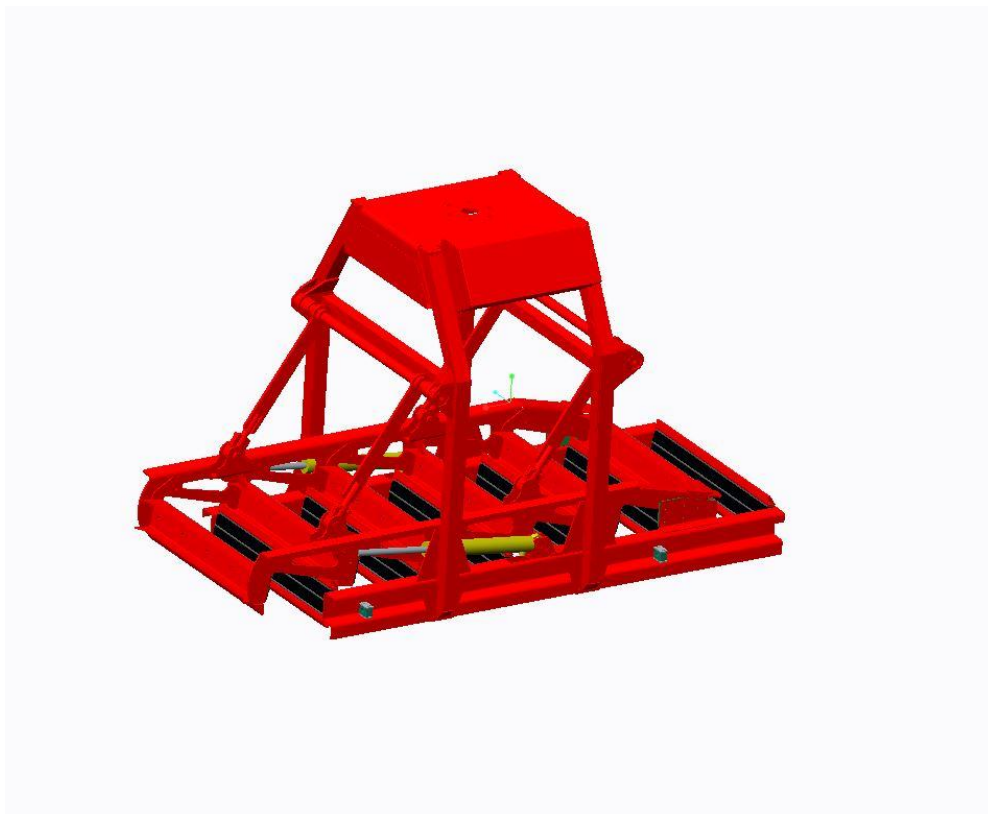
Kuva 3. Naarva P25 kitkevä perkauslaite. Kuva: Pentin Paja.
