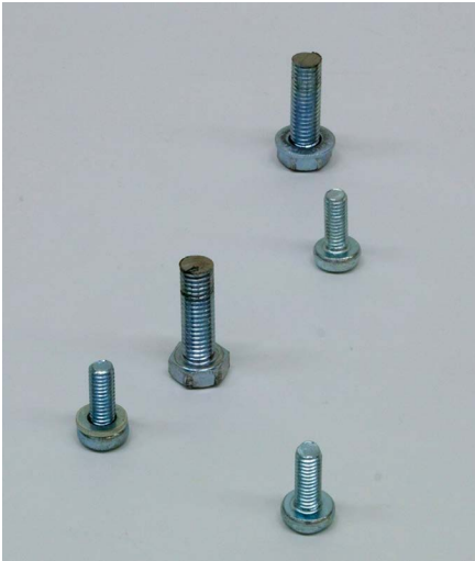
Kuva 2. Kamerasta eri etäisyyksillä olevat ruuvit, joiden etäisyyksiä selvitetään Depth from focus -tekniikalla.
