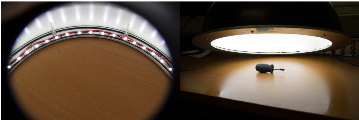
Kuva 6. a) Diffuusikupolin yläpuolen reiästä kuvatut LEDit, joiden tuottama valo heijastuu kupolin sisäpinnalta kohteeseen. b) Diffuusikupolivalaisin kohteen yläpuolella.
