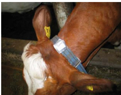
Kuva 5 a. Lehmiin sijoitetut radionapit ja Kuva 5 b. Kiihtyvyyssanturin mittaustiedot tietokoneella.
