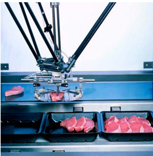
Kuva 2. Konenäköjärjestelmän ohjaama Delta-robotti poimimassa pihvejä liukuhihnalta pakkauksiin (PickMaster, a productivity... 2014).
