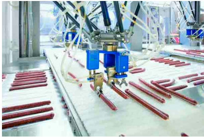
Kuva 3. Delta-robotti poimii makkarointa liukuhihnalta (Reynolds 2007).
