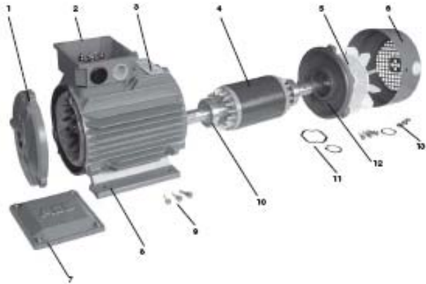
Kuvio 3. Oikosulkumoottorin rakenne avattuna (löytyy sivulta 250 seuraavasta osoitteesta) http://library.abb.com/global/scot/scot259.nsf/veritydisplay/fe82a5091b6f056cc2256f3c001acbd/$File/Drive%20IT%20pienjannitteiset%20vakiomoottorit%20FI%2010-2004.pdf
