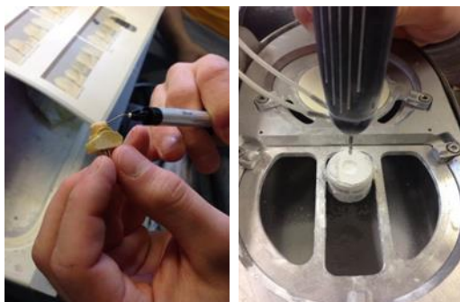
Kuvio 22. Muovisen mallirungon valmistaminen ja hupun jyrsiminen
