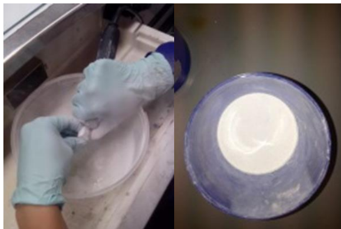
Kuvio 5. Zirkoniaylijäämän poraaminen kovametalliporalla ja siitä saatu jauhe
