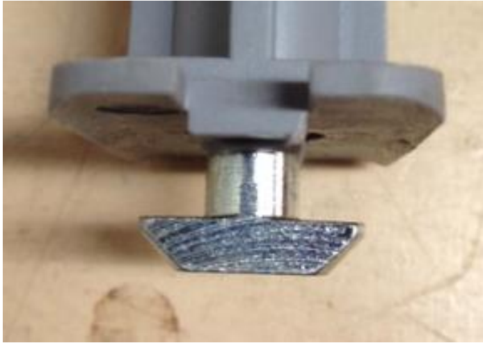
KUVA 9. Suurennus vaakaprofiilin lukkorungosta.
