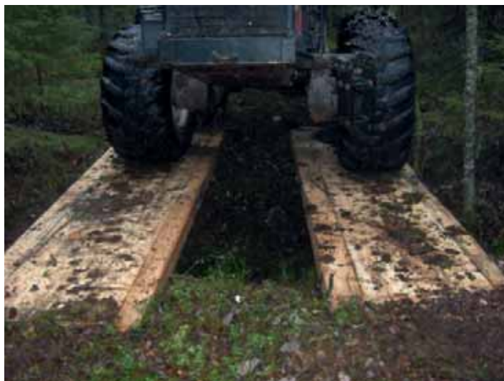
PICTURE 1. Tested wooden driving bridges (Jääskeläinen 2009).
