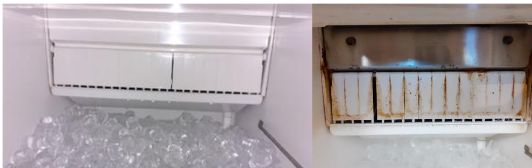
Kuva 3. Vasemmalla kuva jääpalakoneesta, jonka puhtaus sisäpuolelta arvioitiin hyväksi ja oikealla jääpalakone, jonka puhtaus sisäpuolelta arvioitiin huonoksi.
