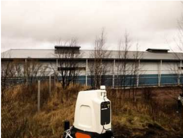
Kuva 10. NaturalPowerZephIR 300 Lidar-laite maastossa. (23.)
