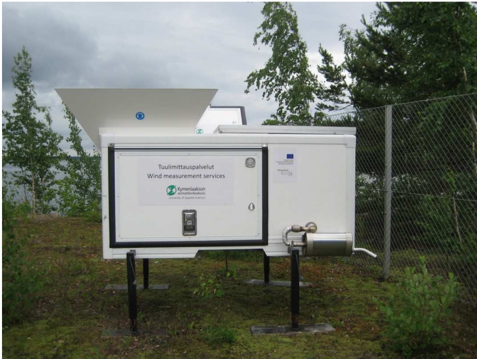
Kuva 11. Kymenlaakson ammattikorkeakoulun Sodar-mittalaite tuulenmittauspaikalle asennettuna.
