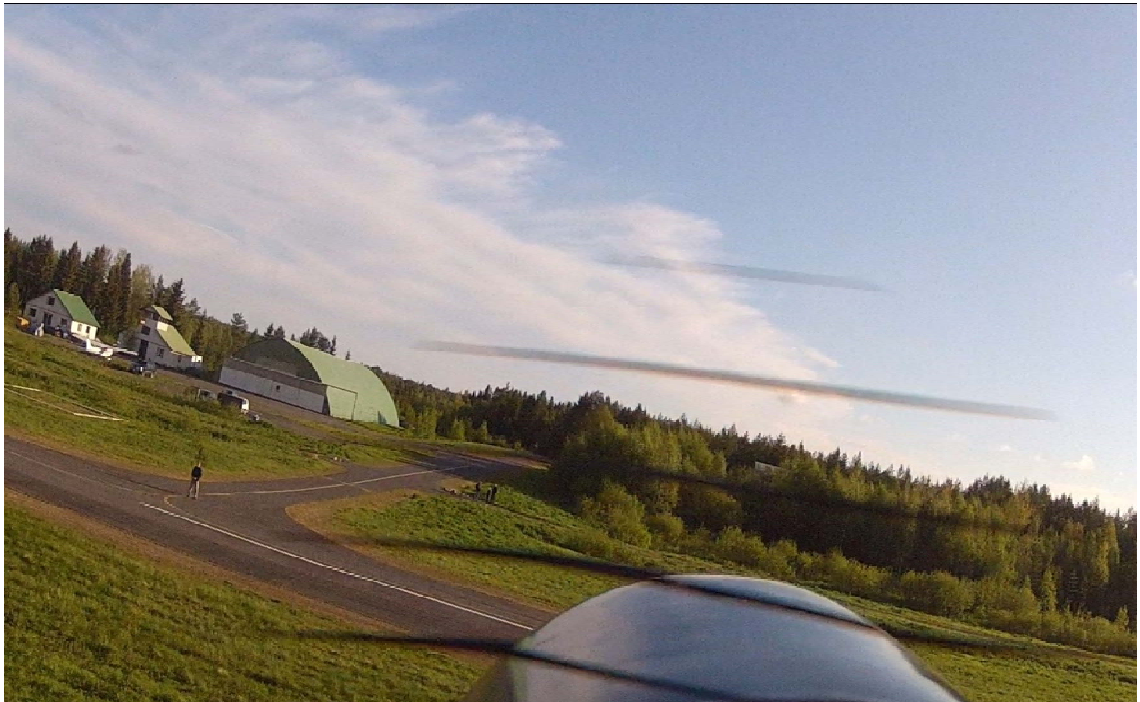
Kuva 9. CCD- videokameran Shutter-efekti nopeasti pyörivästä potkurista
