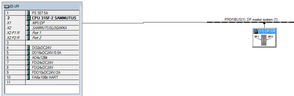
KUVA 33. DP/DP-linkki liitettynä STEP 7:n HW Configissa Profibus DP -väylään
