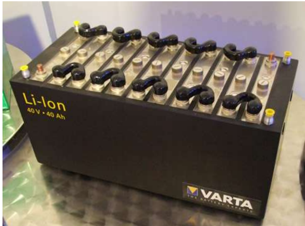
Kuva 18: Vartan litium-ioni –sähköautoakku /31/
