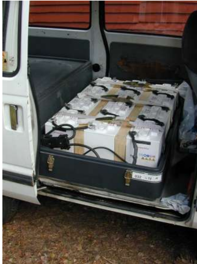
Kuva 16: Elcat Cityvan 202 –sähköauton lyijylevyakusto /25/
