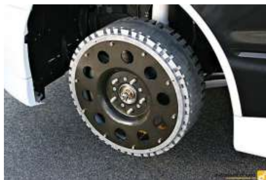
Kuva 10: Shell Eco-Marathon 2006 –kilpailun Saksan joukkueen suunnittelema napamoottorikonstruktio /34;35/.
