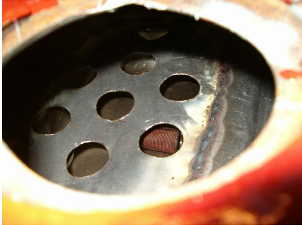
Kuva 5 Muokattu polttoainesäiliön pohja
