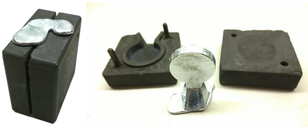
Kuva 11. Sulasta sinkistä valettu näyte
