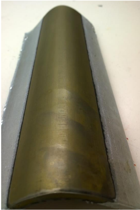
Kuva 21. Levynäyte josta syövytetty sinkkiä pois
