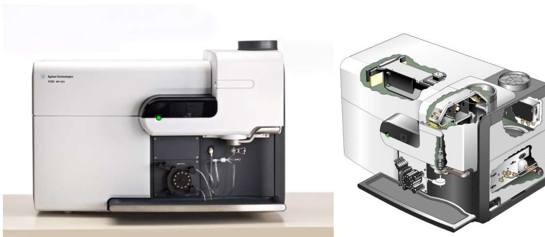
Kuva 10. Analysoinnissa käytetty mikroplasma atomiemissiospektrometri [28]
