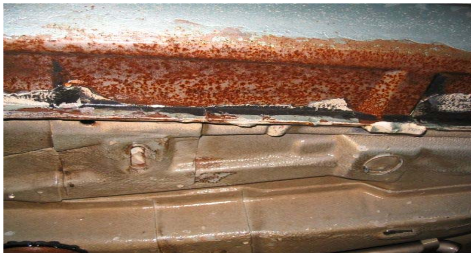
Kuva 2 Ford Mondeon vm-01 helma, josta muovinen kiveniskupinnoite on irronnut
