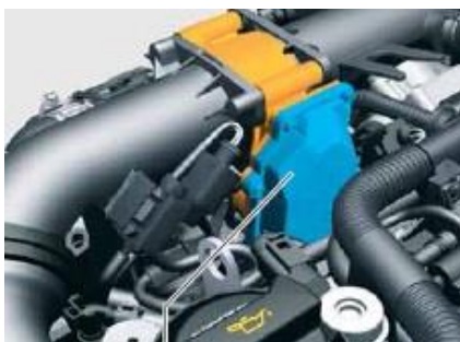
Kuva 36. Säätoläpän ohjainyksikkö, jossa säätoläpän säätömoottori V380
