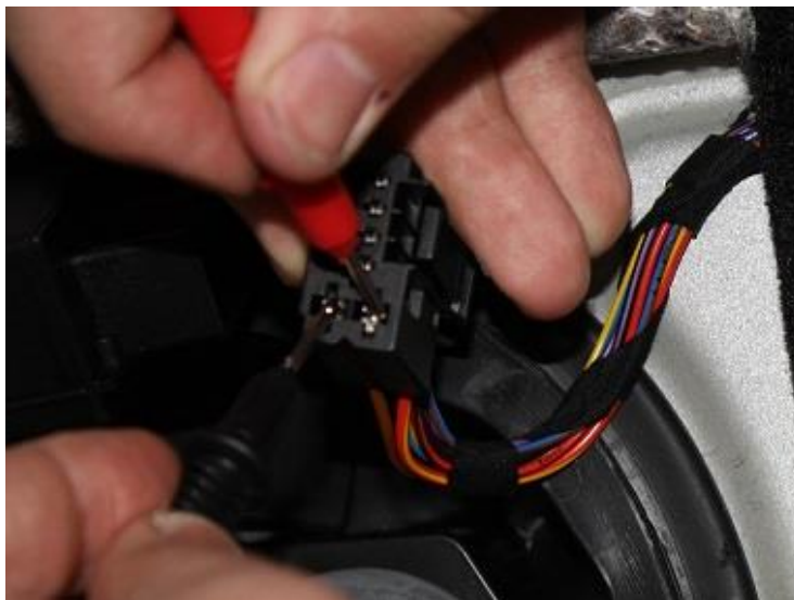
Kuva 57. Polttonesteen ohjainlaitteen syöttöjännitteen mittaus (Mikko Rikalainen 3/2014)
