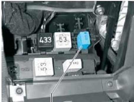
Kuva 50. Lisävesipumpun rele J496 (SSP 443 s.64)
