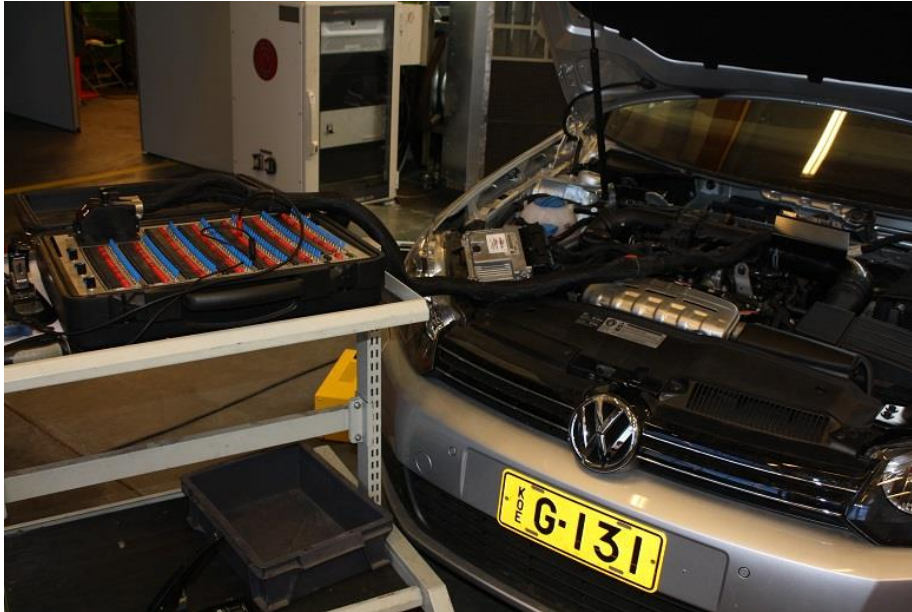
Kuva 59. Break-Out-Box:n kytkeminen (Mikko Rikalainen 3/2014)
