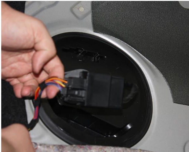
Kuva 56. Polttoainepumpun ohjainlaitteen irrotus (Mikko Rikalainen 3/2014)
