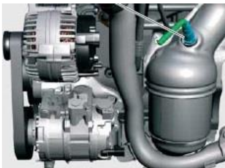
Kuva 28. Lambda-anturi G39, jossa lambda-anturin lämmitys Z19 (SSP 443 s.73)
