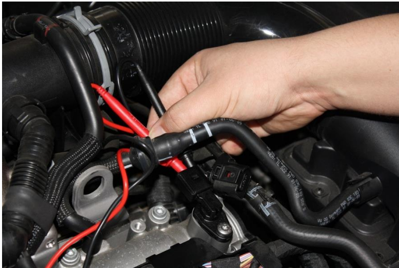
Kuva 54. Nokka-akselin asentotunnistimen vastuksen mittaus (Mikko Rikalainen 3/2014)
