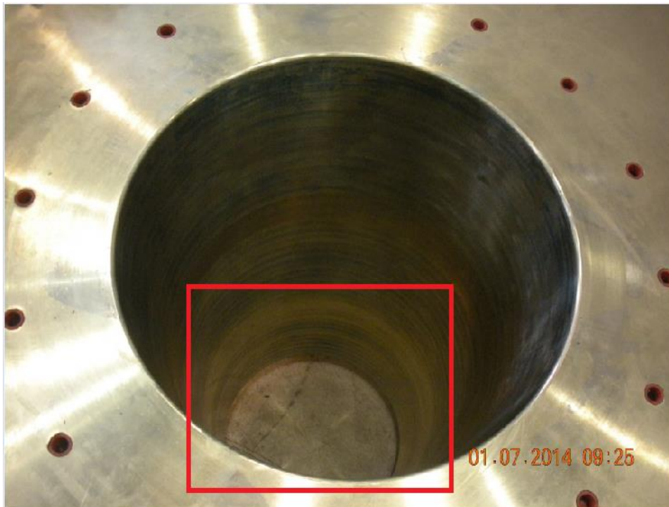
Kuva 2. Napakartio, jossa muotovirhe näkyy vaaleana perusmateriaalina.
