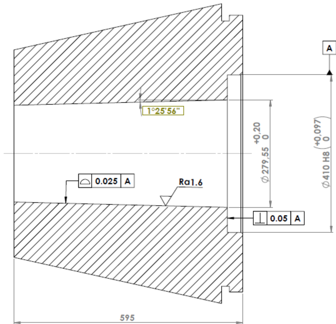
Kuva 18. Napakartion mitoitus GPS-standardia käyttäen.
