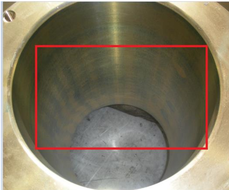
Kuva 3. Napakartio, jossa esiintyy pystyraitaa.
