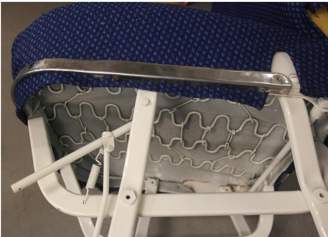
KUVA 18. Istuinosan verhoilun kiinnitys metallikehikolla (Kuva: Heidi Soili 2014)
