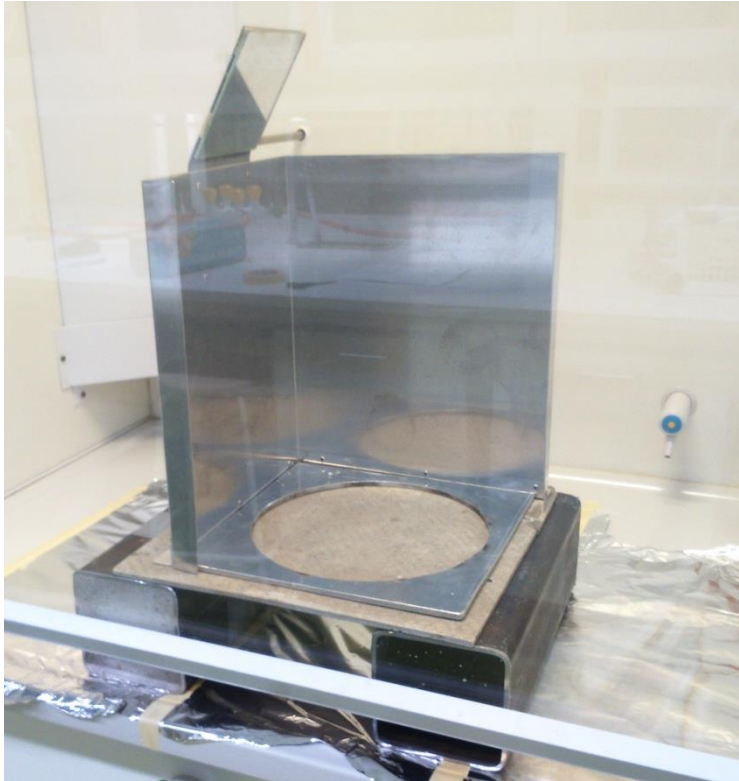
KUVA 6. Vetokaapissa oleva polttokammio (Kuva: Heidi Soili 2014)
