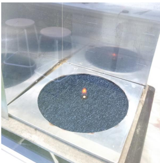
KUVA 7. Maton palokäyttäytymisen testausta tablettikokeella (Kuva: Heidi Soili 2014)
