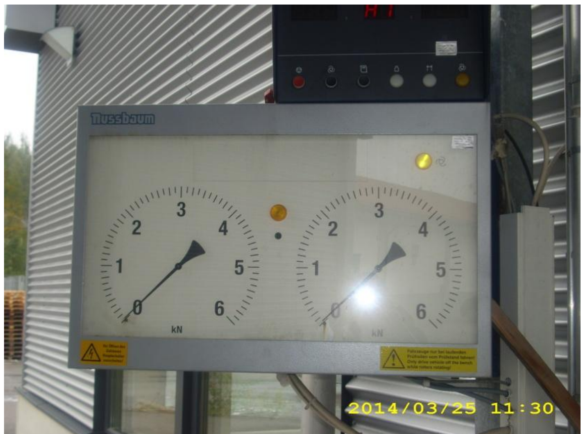
KUVA 1. Nykyinen jarrudynamometri pienellä näyttöasteikolla
