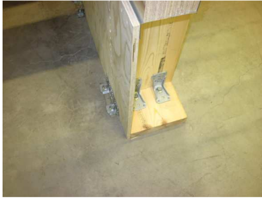
Kuva 33. Koekappaleen kiinnitys betoniin
