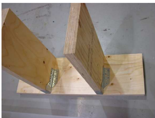
Kuva 19. Kerto-S-palkkien kiinnitys palkkikengillä Kerto-Q-palkkiin
