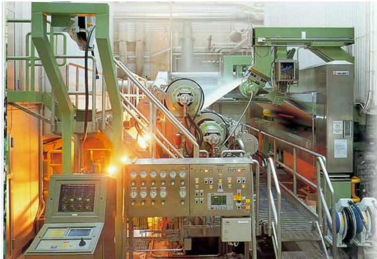
Kuva 3 Filmiliimapuristin radan molemminpuoliseen pintaliimaukseen /21/
