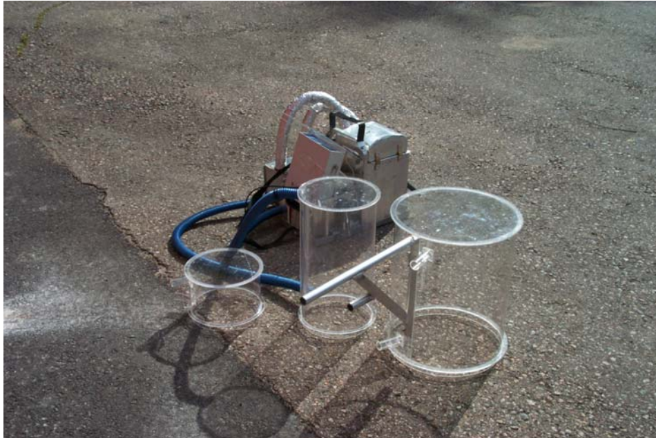
Kuva 1. Etualalla maastomittauksissa käytettävät CO 2 -mittauskammiot, niiden takana kannettava infrapuna- CO 2 -analysointilaitteisto kytkettynä jäähdytysjärjestelmään.
