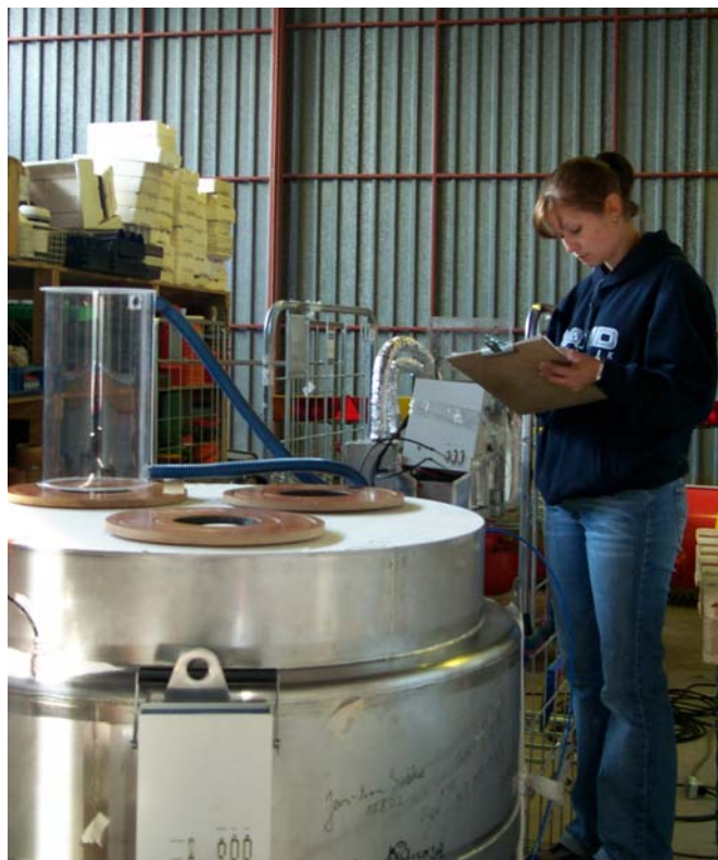
Kuva 8. CO 2 -pitoisuuden mittausta kalibrointitankin hiekan päältä. /7/
