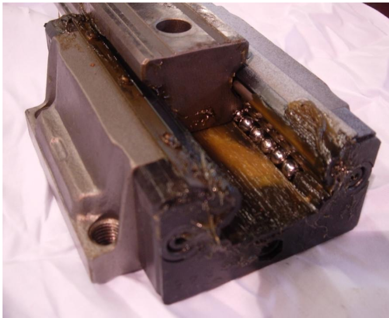
Kuva 18. Vanha, liasta vaurioitunut johdekelkka. /11/
