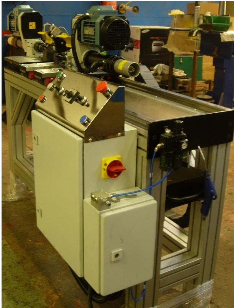
Kuva 15. Koneen paineilmaventtiilit ovat pienemmässä kaapissa. /11/
