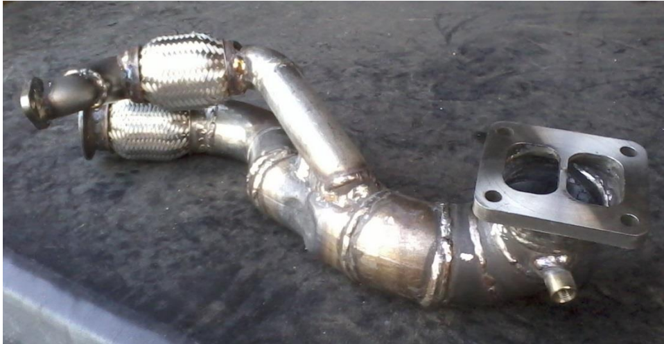
KUVA 8. Turbiinien välinen putki valmiina (Markus Laari 2014)
