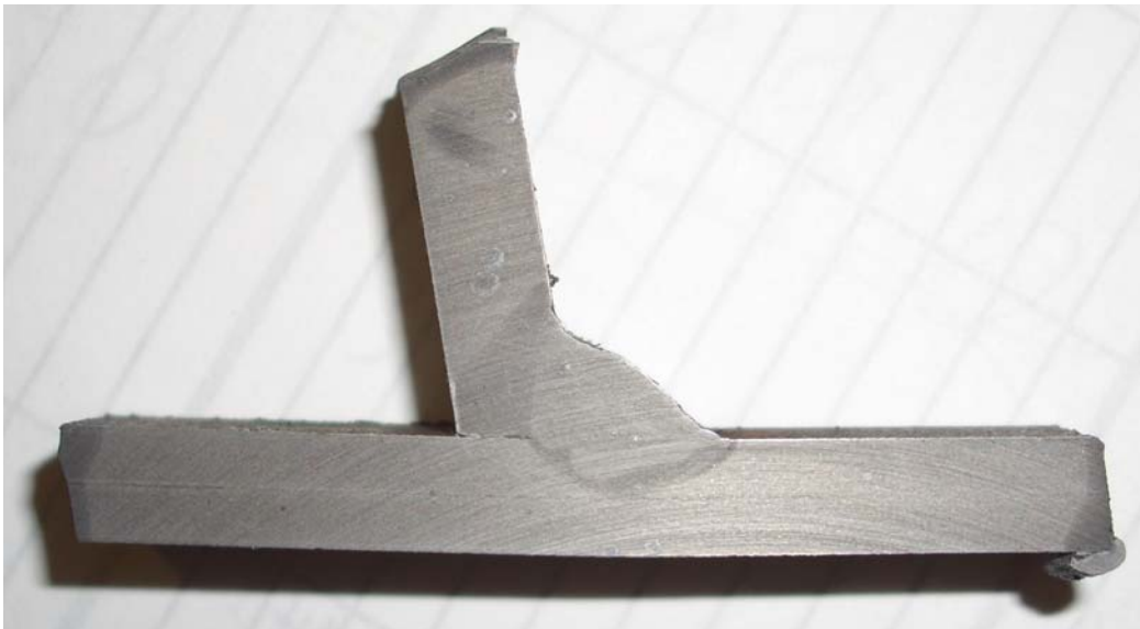
Kuva 12. Hie pulssihitsaustekniikalla tehdystä deltapalkista (Japani, 2005).
