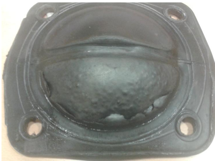
Kuva 11. Höyryn vaurioittama venttiilikalvo. Kalvoventtiilin höyrypuoli on turvonnut ja palkeenkielillä.
