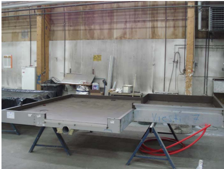
Kuva 14 Kylpyhuoneen pohja 2 (sauna)
