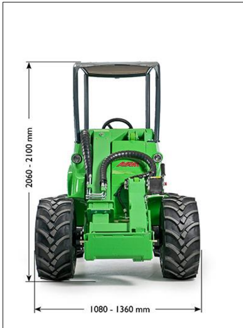
Kuva 2. Avant 750:n mitat edestä (Avant 750 B 2014)
