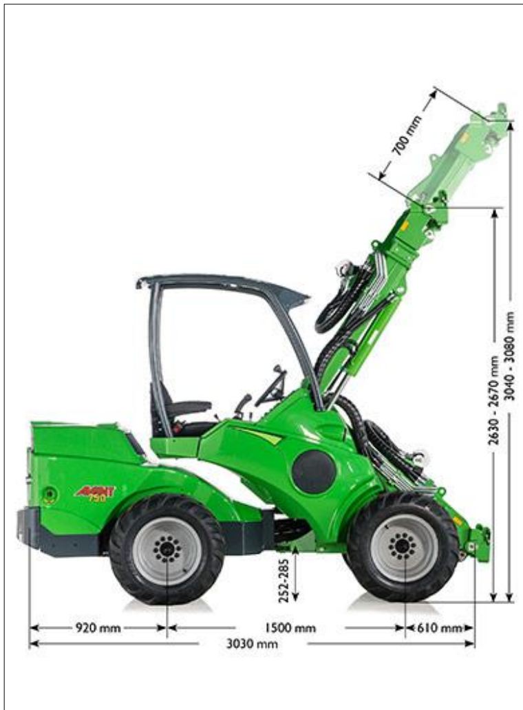
Kuva 1. Avant 750:n mitat sivusta (Avant 750 A 2014)
