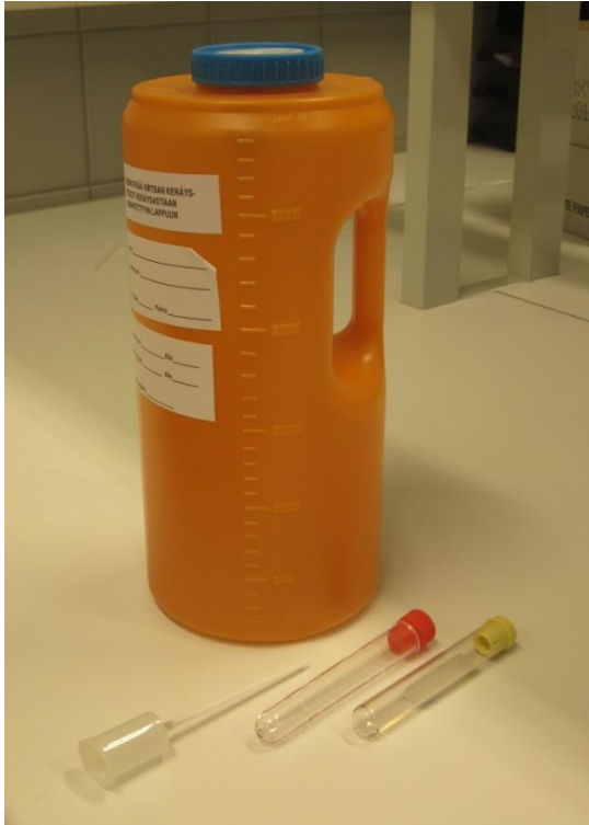
KUVA 2. Keräysvirtsa-astia (BD Vacutainer, 3 l), virtsansiirtoadapteri ja esikäsitelyyn tarvittavat putket (Kuva: Jasmin Koski 2014)
