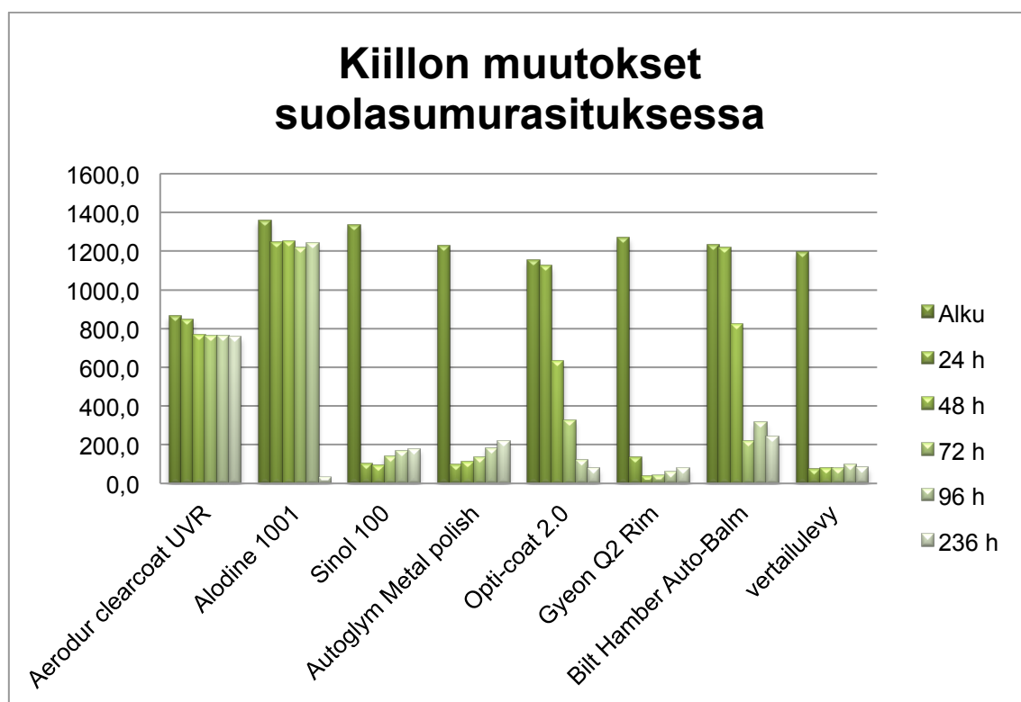
Kuva 9. Kiillon muutokset suolasumurasituksessa.
