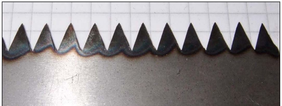
Kuva 14 Palojälkiä kolmannen hiontakokeen toisen koekappaleen alapinnalla
