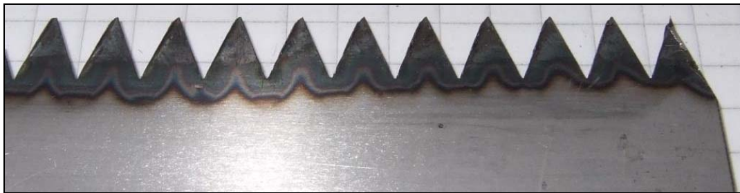
Kuva 17 Palojälkiä neljännen hiontakokeen koekappaleen alapinnalla
