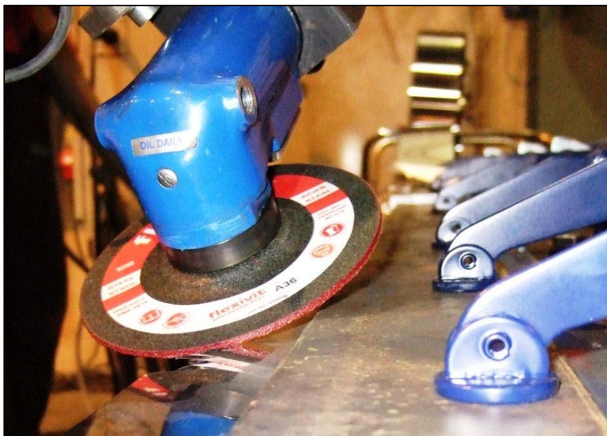
Kuva 9 Pikakiinnittimien painama lattarauta puristaa työkappaletta työpöytää vasten.
