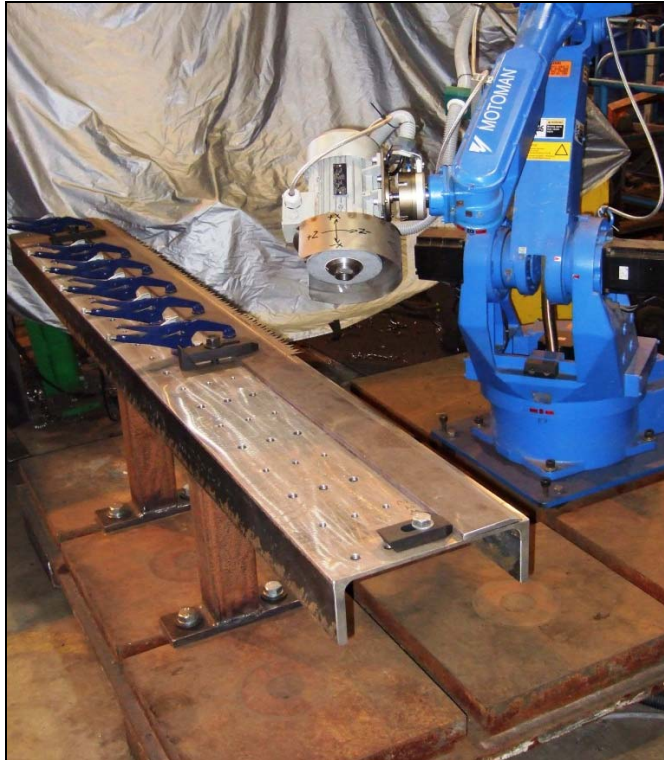
Kuva 6 Robotti ja työpöytä asennettuina massiiviselle metallilaatalle
