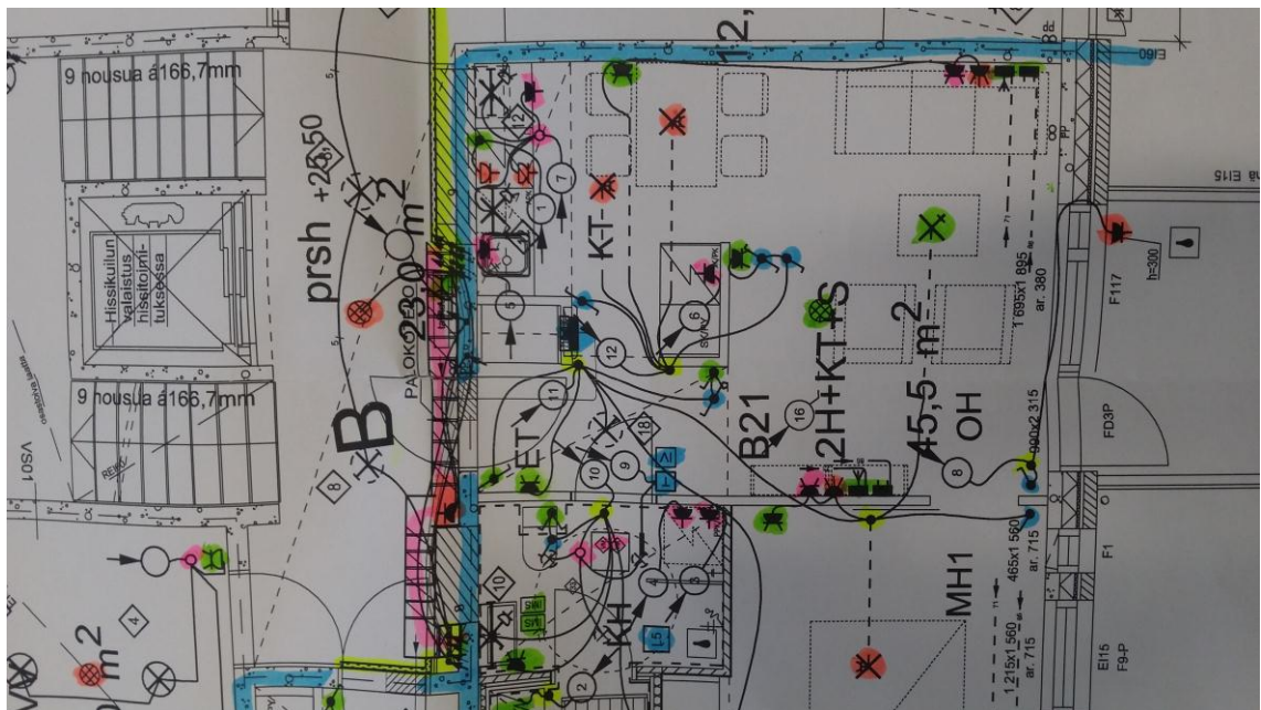
Kuva 2. Sähkölaitteiden ja kalusteiden laskenta.
